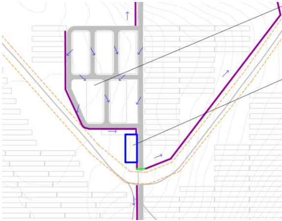
Kuva 28 Esimerkki akkuvarastoalueen vesienhallinnasta
